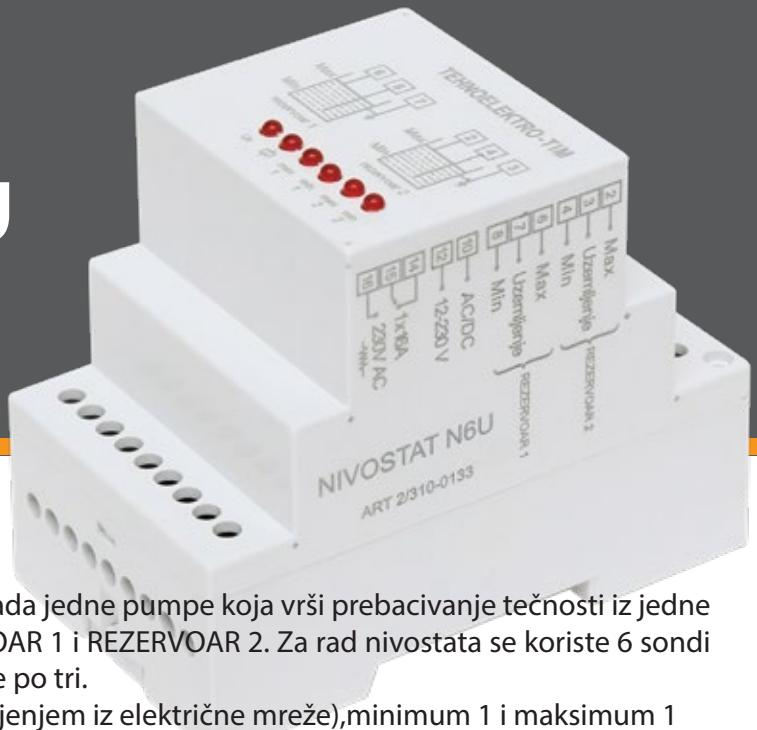
**NIVOSTAT N-6/U** je uređaj namenjen za kontrolu rada jedne pumpe koja vrši prebacivanje tečnosti iz jedne posude u drugu u našem slučaju nazvane REZERVOAR 1 i REZERVOAR 2. Za rad nivostata se koriste 6 sondi raspoređene tako da se u svakom rezervoaru nalaze po tri.
