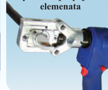
presovanje spojnih elemenata
