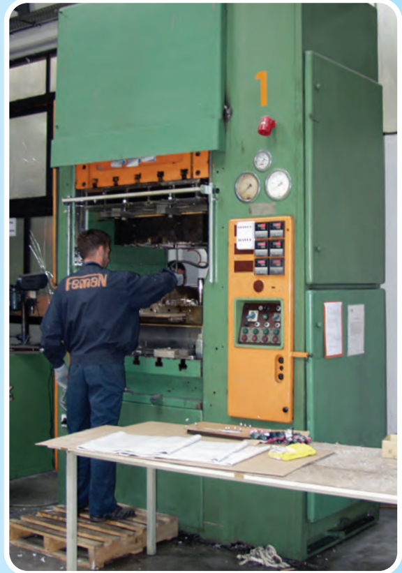
Pogon sa sedam vertikalnih savremenih hidrauličnih presa od 200 do 1000 tona.
